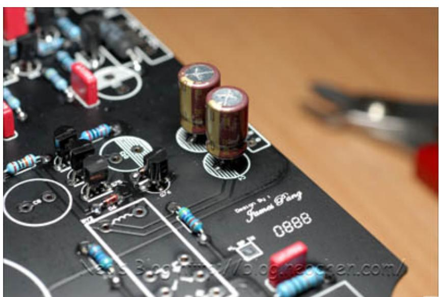
C9~C18的220u電解電容,有方向性,電容上有白線的那端要對照
