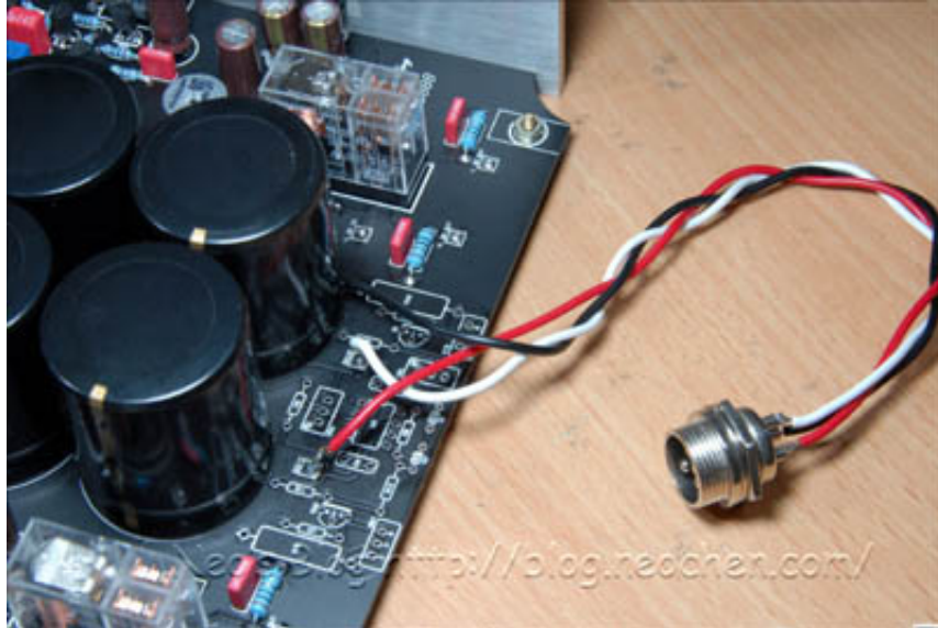
電路板上的焊點 紅線是正電,白線是負電,黑線是地
