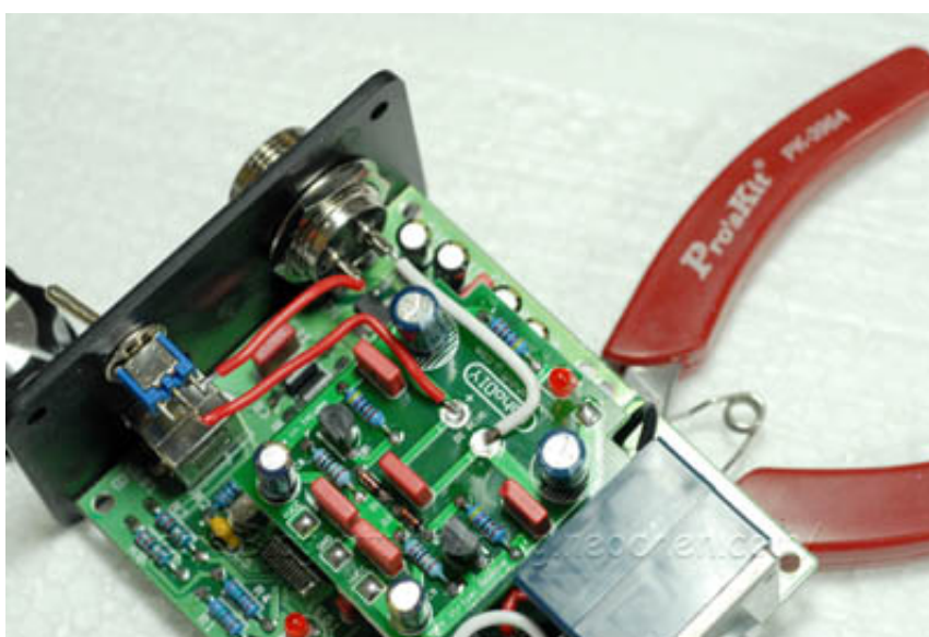
再來將虛擬地的輸出拉到NeoMini DigiAmp的電源輸入端 正/負/Ground都標示的蠻清楚的,別拉錯了
