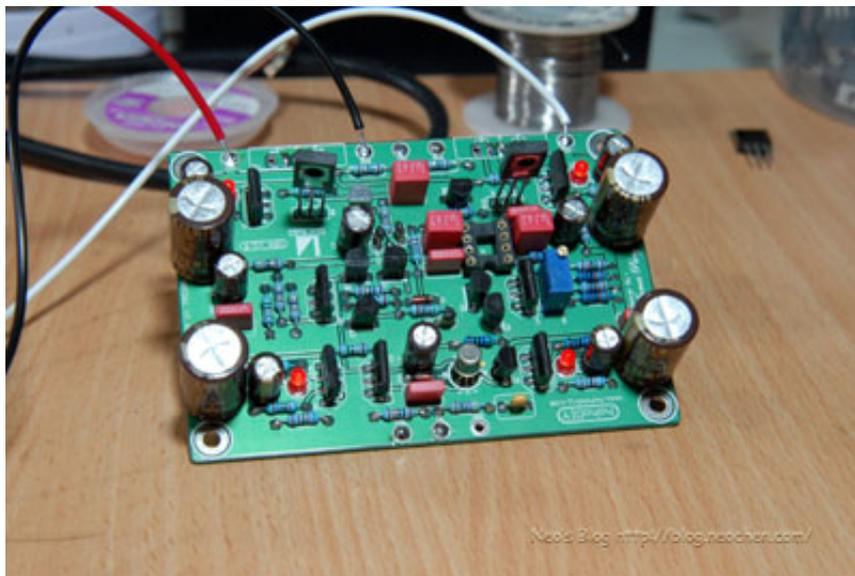
2.先今輸入短路(in與gnd焊起來),電表的紅色探棒放在out,黑色探棒放在gnd,OP先不要上
