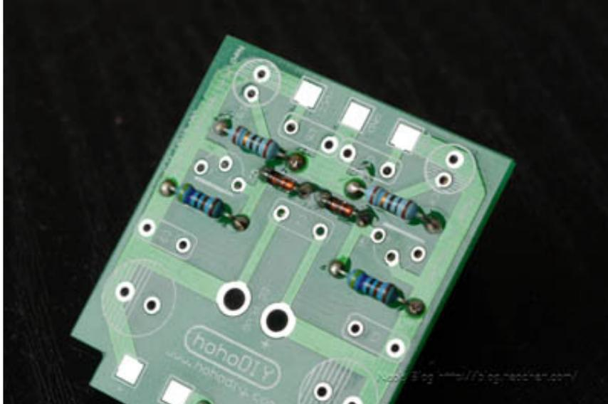
再來是Q1的C2240,請依照電路板印刷的方向插入即可
