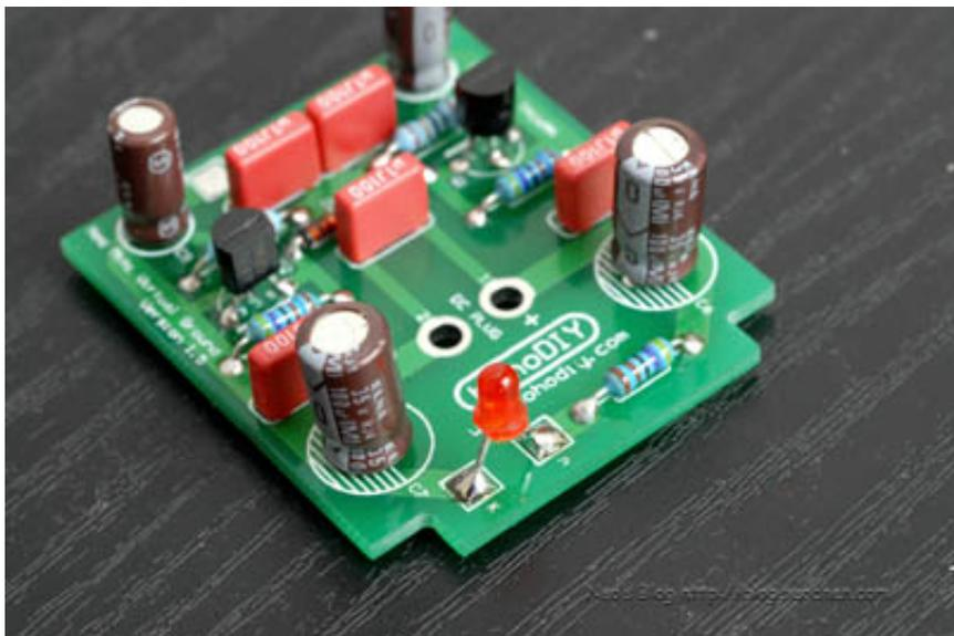
最後,準備上電測試,正中央那兩個大洞就是電壓輸入的地方,1為正2為地
