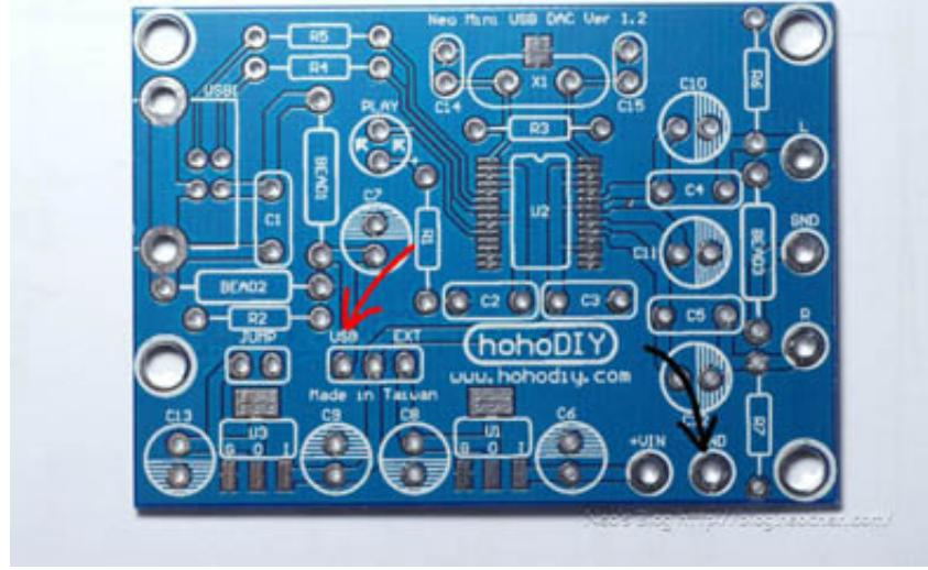
先將USB線拔離電腦,然後將下圖中紅線處短路,如果不惡搞的話,
