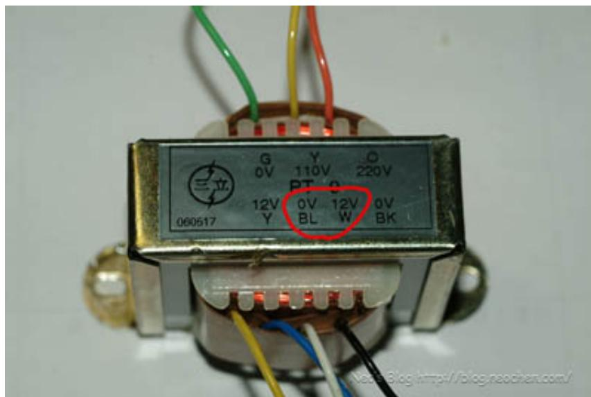
然後將藍白兩線焊到電路板上In那三孔中間的G孔
