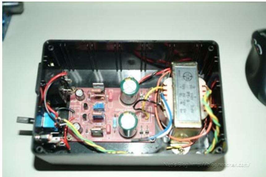
本AC套件開機約需要十秒左右的時間,才能進入正常的工作電壓...
